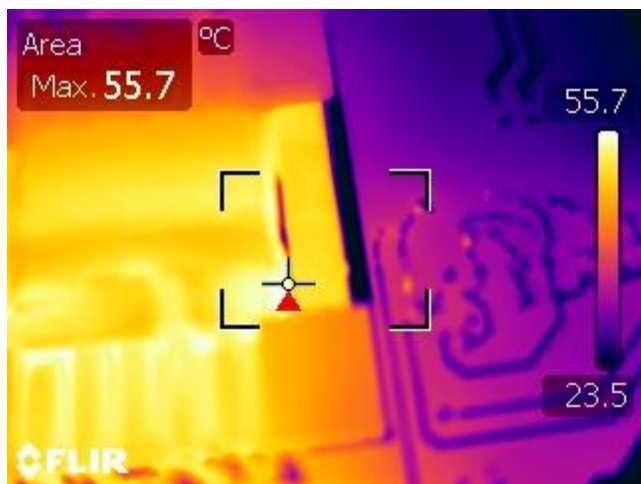
図 33 - 室温での最大負荷トランス (T1) の温度表示
